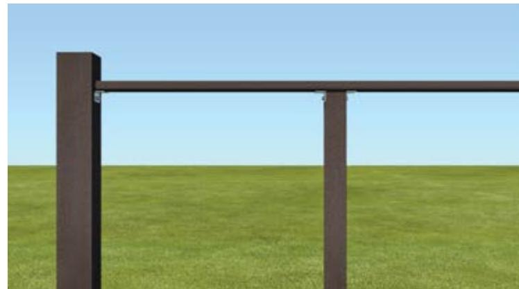
**Также вы можете усилить конструкцию декоративного ограждения.** Для этого перед установкой перил в них требуется вставить армирующий профиль 15x15, закрепить его внутри перил при помощи оконных саморезов через предварительно просверленные отверстия с шагом не более 100 мм.
